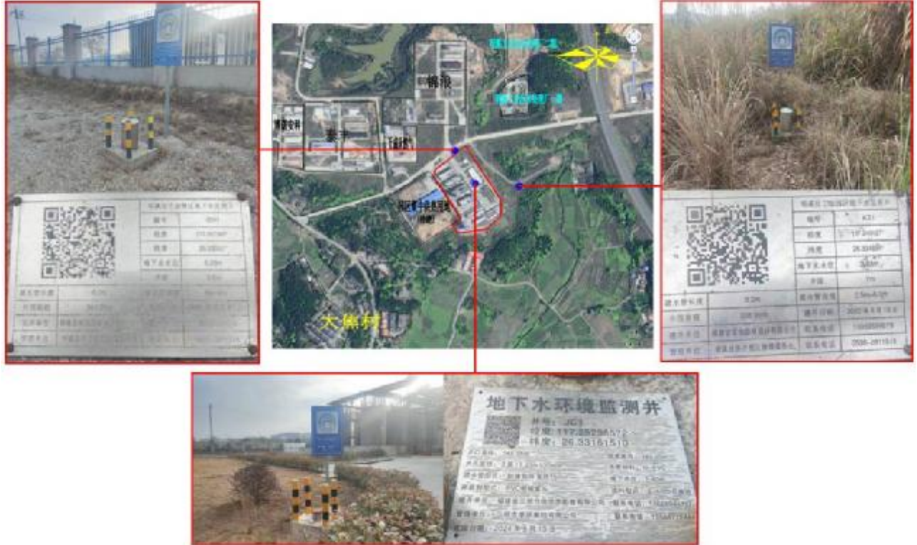
图 2.7-5 地下水监控井分布与现状照片
