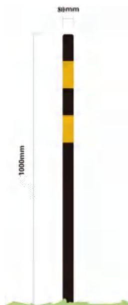
图 6.6- 9 地下水监测井警示柱图示及尺寸
