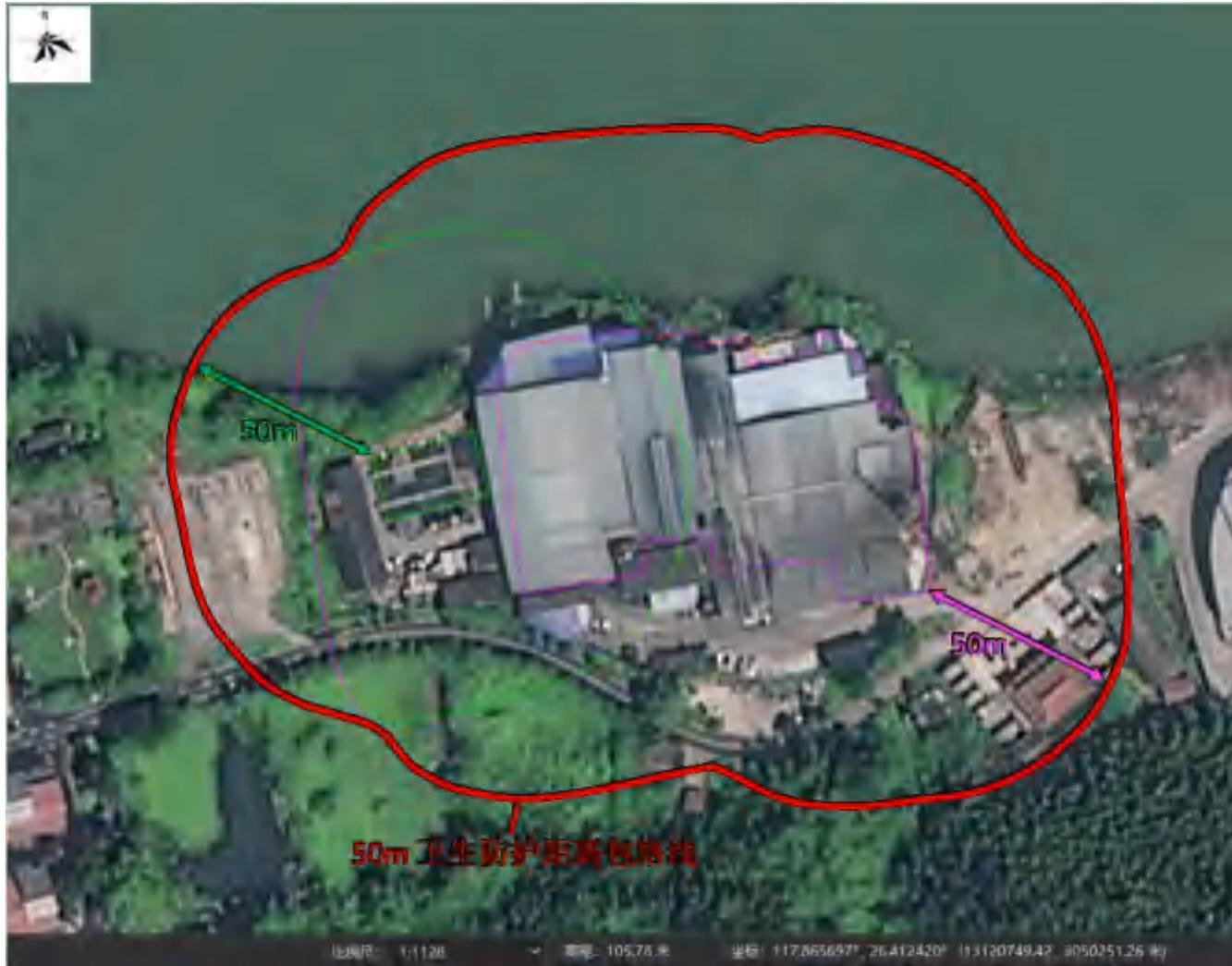
图 6.2- 13 技改项目卫生防护距离包络图
